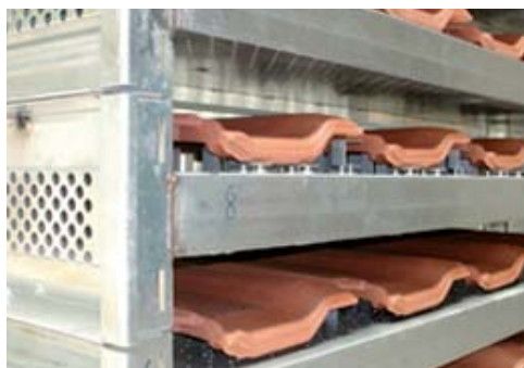
Rysunek 18. System podstawek kanałowych do dachówek /49/
